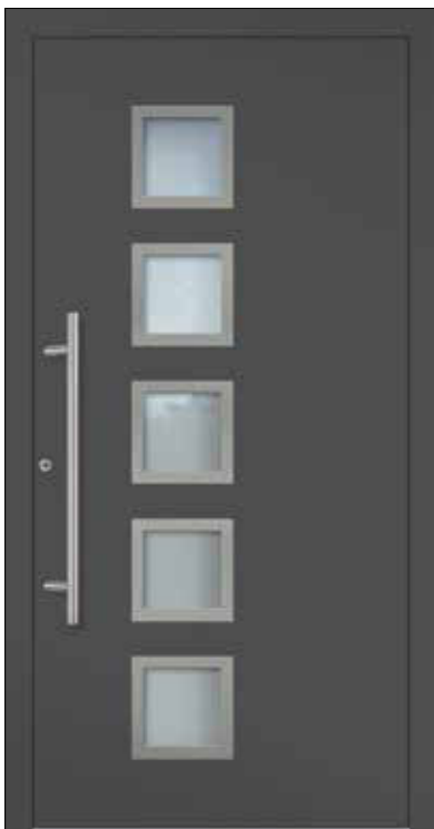
A 15 U_d -Wert 0,80 1) Farbe: DB 703 Eisenglimmer FS Verglasung: Satinato weiß LA 200 x 200 / 1.600 mm Rahmen in Edelstahloptik außen Mindestmaß = 900 x 1.990 mm
